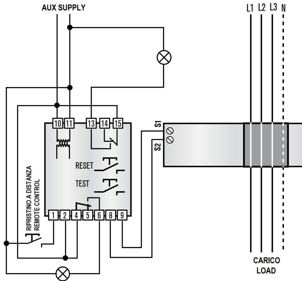
Bobina di minima tensione (BM) - Undervoltage coil (BM)
